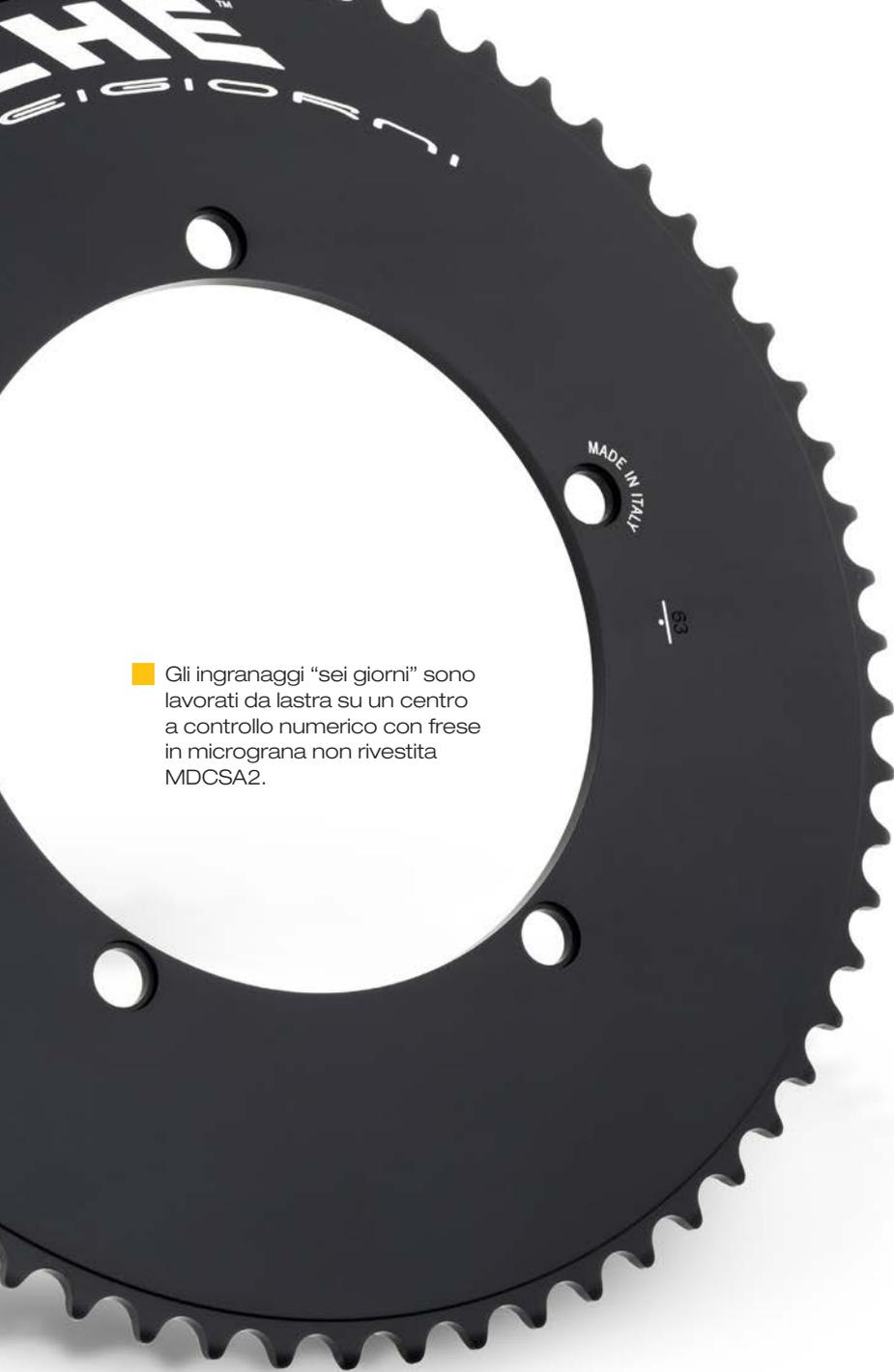
■ Gli ingranaggi “sei giorni” sono lavorati da lastra su un centro a controllo numerico con frese in micrograna non rivestita MDCSA2.
